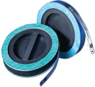
Discos de grafito están hechos de grafito impregnado que ofrece presión de ruptura baja y excelente resistencia a la corrosión. Se suministran los discos de grafito de BS&B con juntas integrales para la instalación directa entre las bridas de tubería internacional. El rango de elementos reemplazables está instalado en el cabezal de seguridad de acero inoxidable o de grafito antes de la instalación entre las bridas de la tubería.
